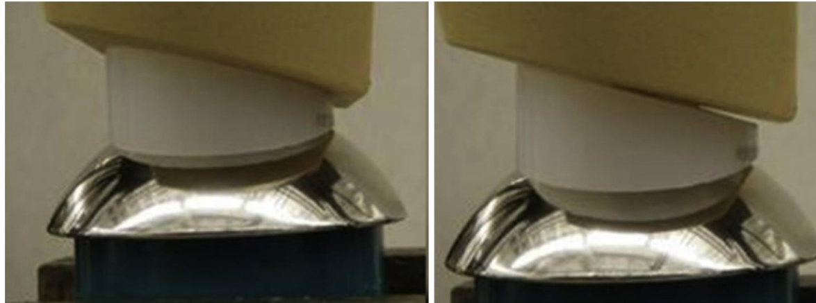
Liftoff antérieur causé par une charge compressive postérieure
